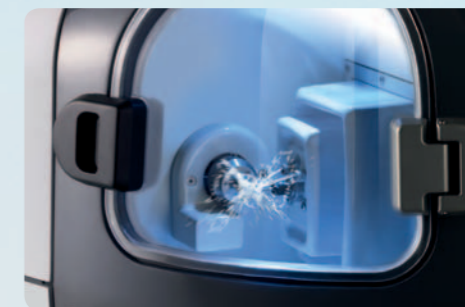
Usinage intelligent de la couronne avec traitement à 4 axes.
